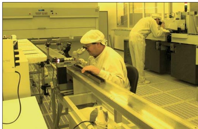
Контрольный пункт проверки шкал в отделе литографии
